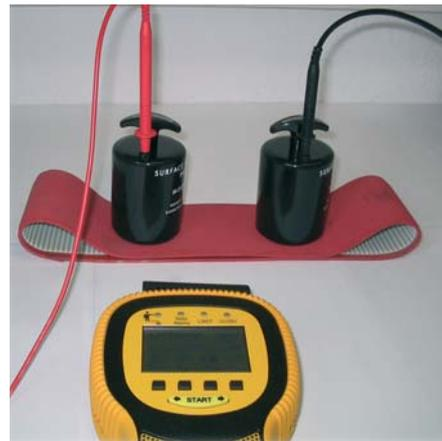
Da während eines längeren Betriebes die Leitfähigkeit der Beschichtung schlechter werden kann, ist eine turnusmäßige Überprüfung anzuraten. Die Messung erfolgt nach DIN EN 61 340-2-3 und DIN EN 340-4-1. Zur Messung kommt ein digitales Hochohmmeter zum Einsatz.
